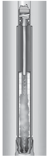
Dampf löscht den Lichtbogen beim ersten Null-Strom
